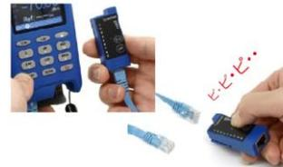
LANケーブルのワイヤマップテスト、断線検査、LAN探索に！
